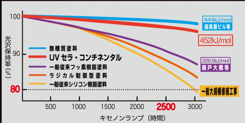
劣化促進機「ウェザーメーター (キセノンランプ)」の照射時間に対する光沢の保持率により耐候性の分類をしています。光沢保持率80%以上が2500時間以上のものを「耐候形1種」、1200時間以上のものを「耐候形2種」、600時間以上のものを「耐候形3種」としています。UVセラ・コンチネンタルは「耐候形1種」以上に相当する結果を示し、特に耐候性にすぐれた塗料といえます。
